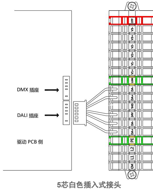
5芯插头用于连接DA+, DA-, 24V, DA+, DA-端子。电源的PCB上有两个标有“DALI”和“DMX”的插座，请将插头位置调整到相应的调光模式。默认调光模式为DALI。
