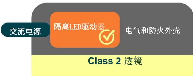
图 7: UL non-Class 2 灯具，仅在透镜中隔离
